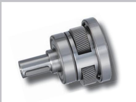
输出行星架采用一体式（双支撑）的结构设计，前后轴承大跨距分布于箱体内部，形成稳定的一体式结构，以确保较高的扭转刚性和精度。
